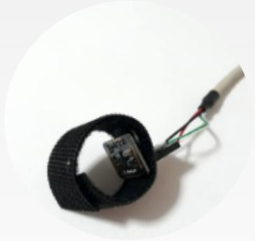
El **sensor de ppg** (fotopletismografía) se conecta en el dedo índice. Éste permite calcular las señales de frecuencia cardíaca y saturación de oxígeno.
