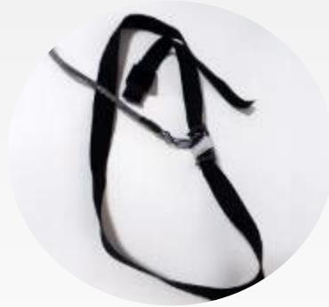
El **acelerómetro** se conecta mediante un cinturón ubicado a la altura del ombligo. Éste captura una señal que se utiliza para calcular la frecuencia respiratoria.
